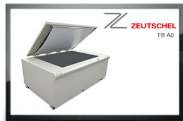
Zeutschel FB0 เครื่องเอกสาร หรือ ผืนชิ้นงานขนาด A0 พื้นที่สแกนสูงสุดที่ 1,270 มม. x 920 มม. ใช้เวลาประมาณ 17 วินาที @ 300 จุดต่อนิ้ว กับ มีชุดเซ็นเซอร์แบบ CCD เรียงแถวเดียว ไม่เกิดปัญหา Stitching อินเตอร์เฟซแบบ กิกะบิตอีเธอร์เน็ต
